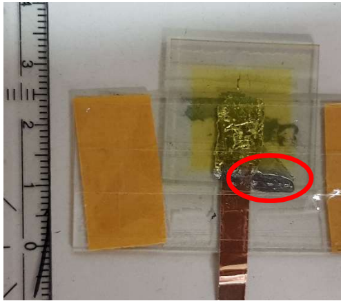
Abbildung 26: Erster Versuch Wie oben bereits erläutert kam es durch die unerwartet schwierig Dosierung des Galinstans zu einem Kurzschluss. Die betreffende Stelle ist rot markiert.
