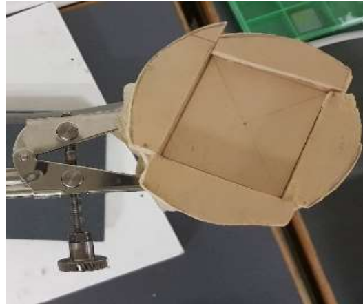
Abbildung 23: Draufsicht des Holztellers. Dieser weist eine mittige Vertiefung von etwa der Größe des zu beschichtenden ITO-Glases auf. Die seitlichen Erhöhungen sollen das Verrutschen des Glassubstrates während des Beschichtungsvorgangs durch Fliehkräfte unterbinden.
