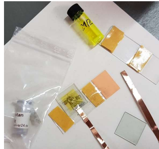
Abbildung 27: Einzelteile des ersten Aufbaus links: Galinstan rechts im Glasfläschchen: SuperYellow® mittig: Fertig zusammengebauter erster Versuch außerdem: Selbstklebende Kupferstreifen, noch unbeschichtetes ITO-Glas und mit doppelseitigem Klebeband versehenes Glasplättchen, auf dem der Kupferkontakt aufgebracht werden sollte.
